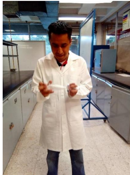
Figura 7. Movimientos circulares para favorecer la extracción líquido-líquido
