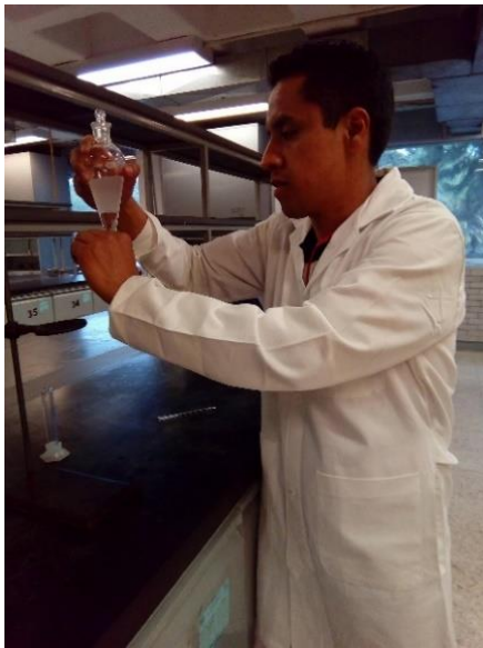
Figura 6. Adición de cloroformo al codestilado
