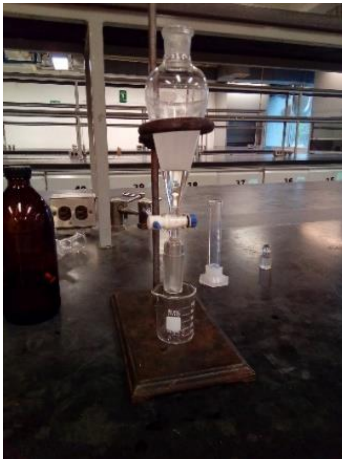
Figura 8. Sistema de extracción líquido-líquido listo para la separación de la fase orgánica (Cloroformo). Observar que el embudo de separación no tiene tapón.
