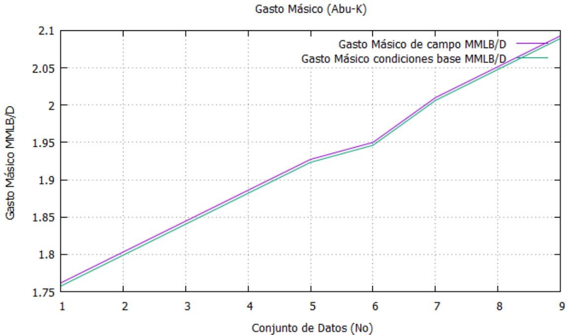
Fig. 6.15- Gráfica comparativa en Gnuplot de gastos máxicos método de campo y método exacto (Abu-K).
