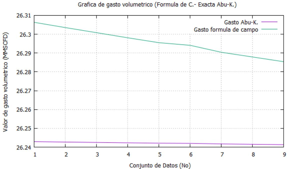
Fig. 6.9- Gráfica comparativa en Gnuplot de gasto volumétrico con formula de campo y método exacto (Abu-K.).
