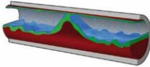
Fig. 1.5 Sección de tubería con flujo tipo slug [2].
