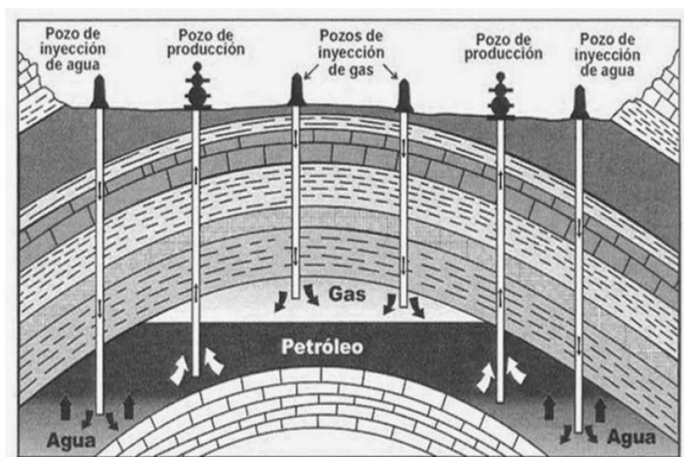
Fig. 5.4.- Esquema de recuperación mejorada utilizando la inyección de agua y gas.
