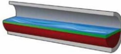
Fig. 1.2 Sección de tubería con flujo estratificado. [2].
