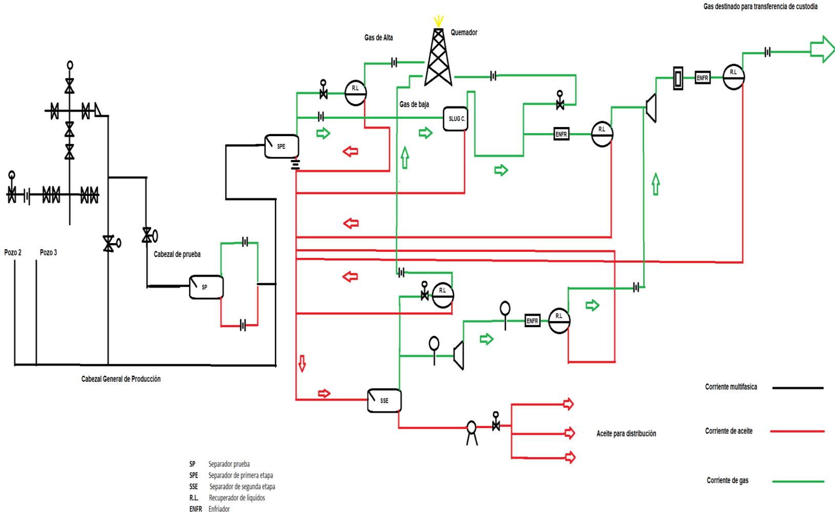
Fig. 5.2.- Esquema general de distribución de gas y aceite
