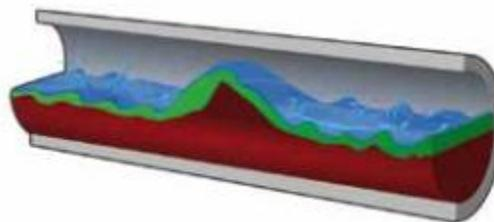
Fig. 1.4 Sección de tubería con flujo tipo semi-slug [2].
