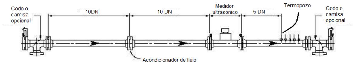
Fig. 4.1 Instalación de medidor ultrasónico para aplicaciones unidireccionales [20].
