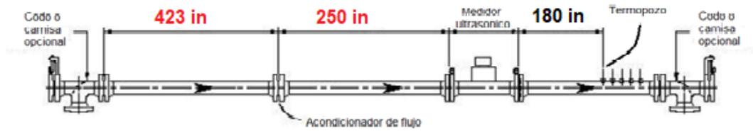
Fig. 5.19.- Instalación de prueba mal diseñada.
