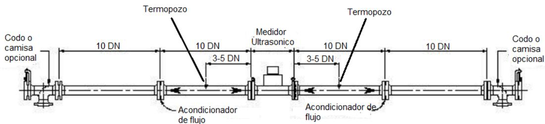
Fig. 4.2 Instalación de medidor ultrasónico para aplicaciones bidireccionales[20].
