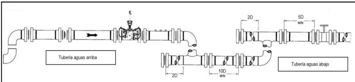
Fig. 4.4 Instalación de medidor ultrasónico considerando dos conectores [18].
