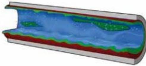
Fig. 1.6 Sección de tubería con flujo tipo anular [2].
