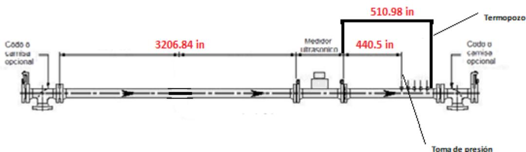
Fig. 6.1 Configuración de la instalación en campo.
