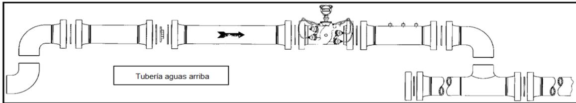
Fig. 4.3 Instalación de medidor ultrasónico considerando el uso de válvulas [18].
