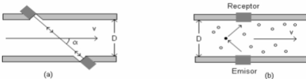
Fig.3.6 Diagrama general del choque de ondas de un medidor, efecto doppler.
