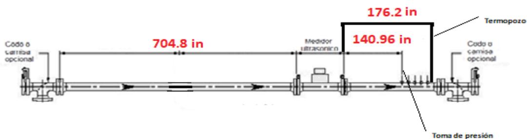
Fig. 6.2 Configuración de la instalación en campo resultante.
