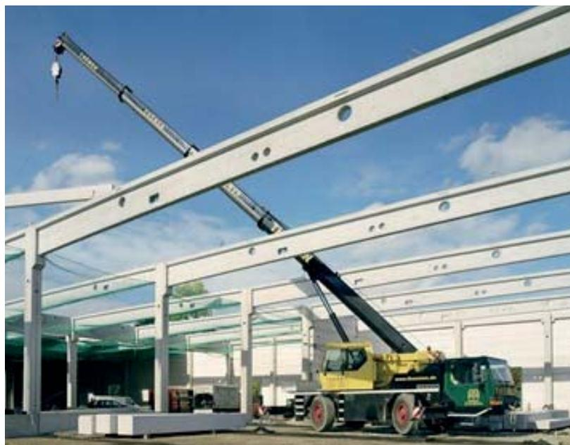
Figura 42. Imagen de grúa LTM 1030-2.1, alcanza un máximo de 44m y soporta hasta 35 ton Liebherr. (2017). Grúa. [Fotografía]. Recuperado de: <https://www.liebherr.com/en/deu/products/mobile-and-crawler-cranes/mobile-cranes/ltm-mobile-cranes/details/ltm103021.html>
