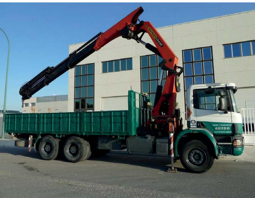
Figura 41. Imagen de grúa PK 40ton/m, su caja es de 6.5m y capacidad de carga de 40 ton. Agudo grúas y transportes. (2016). Grúa. [Fotografía]. Recuperado de: <http://www.gruasagudo.es/camiones-grua/camion-grua-pk-40-tn-m/>
