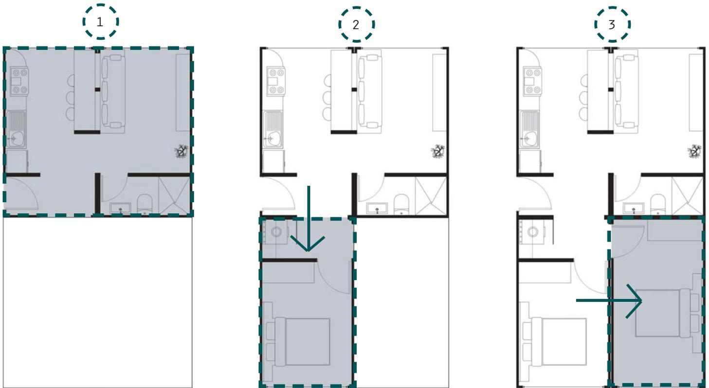
Figura 23. Hábitat.uno horizontal: el crecimiento por módulos se muestra en línea punteada.
