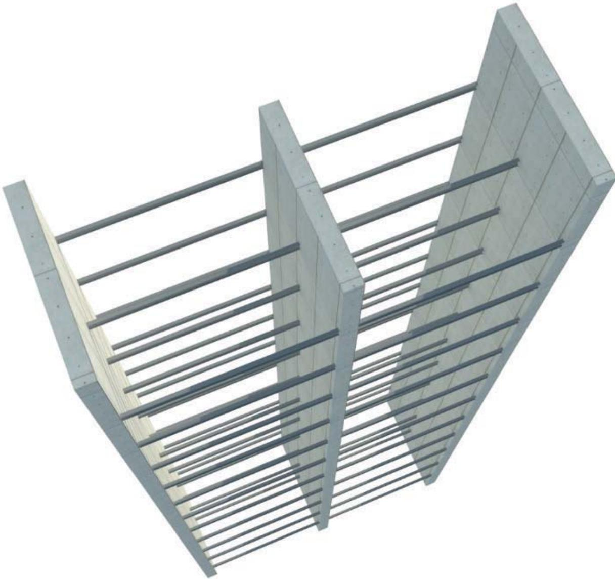
Figura 39. Las vigas IPR terminan transmitiendo la carga de los hábitats a los muros de concreto donde están ancladas.
