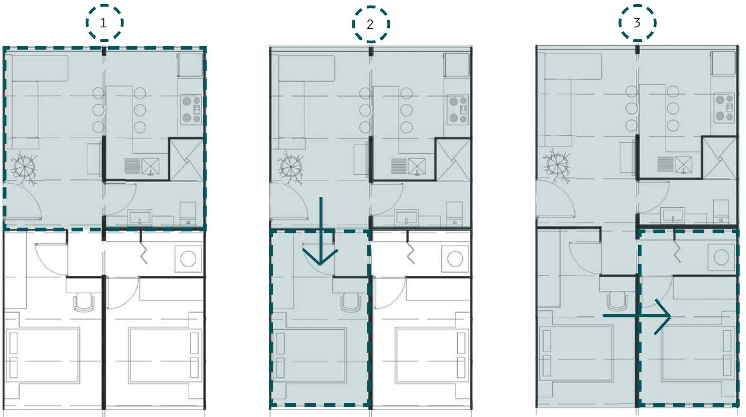
Figura 23. Hábitat.dos H: el crecimiento por módulos se muestra en línea punteada.
