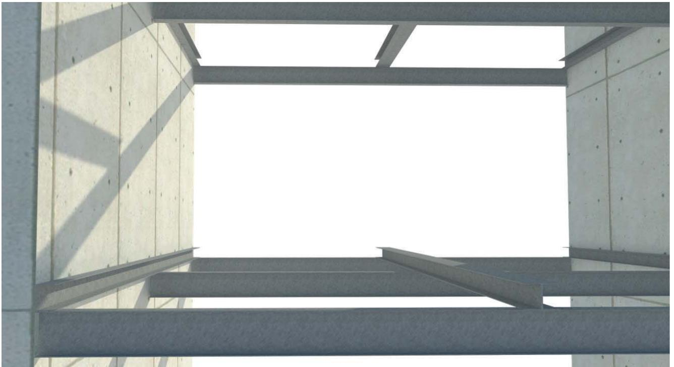
Figura 37. A su vez el canal CE se apoya en las vigas IPR.
