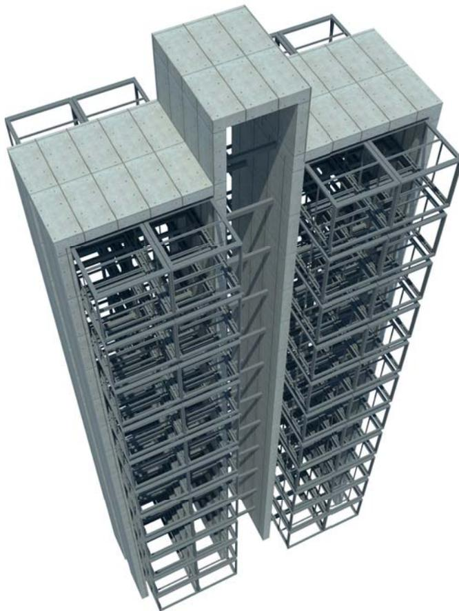
Figura 91. Losa y cimentación forman un anillo rígido.
