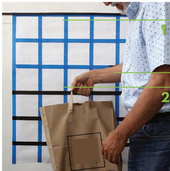
Después de concretar las pruebas básicas se procedió a encontrar el punto de falla de la bolsa, con una mezcla de los movimientos antes mencionados, a los 5 minutos de constante movimiento la bolsa empezó a presentar fallas en el ensamble del asa al cuerpo, así como daño al cuerpo (pero no estructural).
