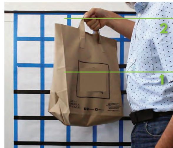
En el segundo paso, se tomó como referencia la altura máxima al momento de levantar y la posición final al caer, promediando en una caída de 27 cm a 30 cm. La prueba se realizó con 4 Kg. durante 3 minutos con movimiento intenso. La bolsa no presentó falla, pero si daño visual después de la prueba.
