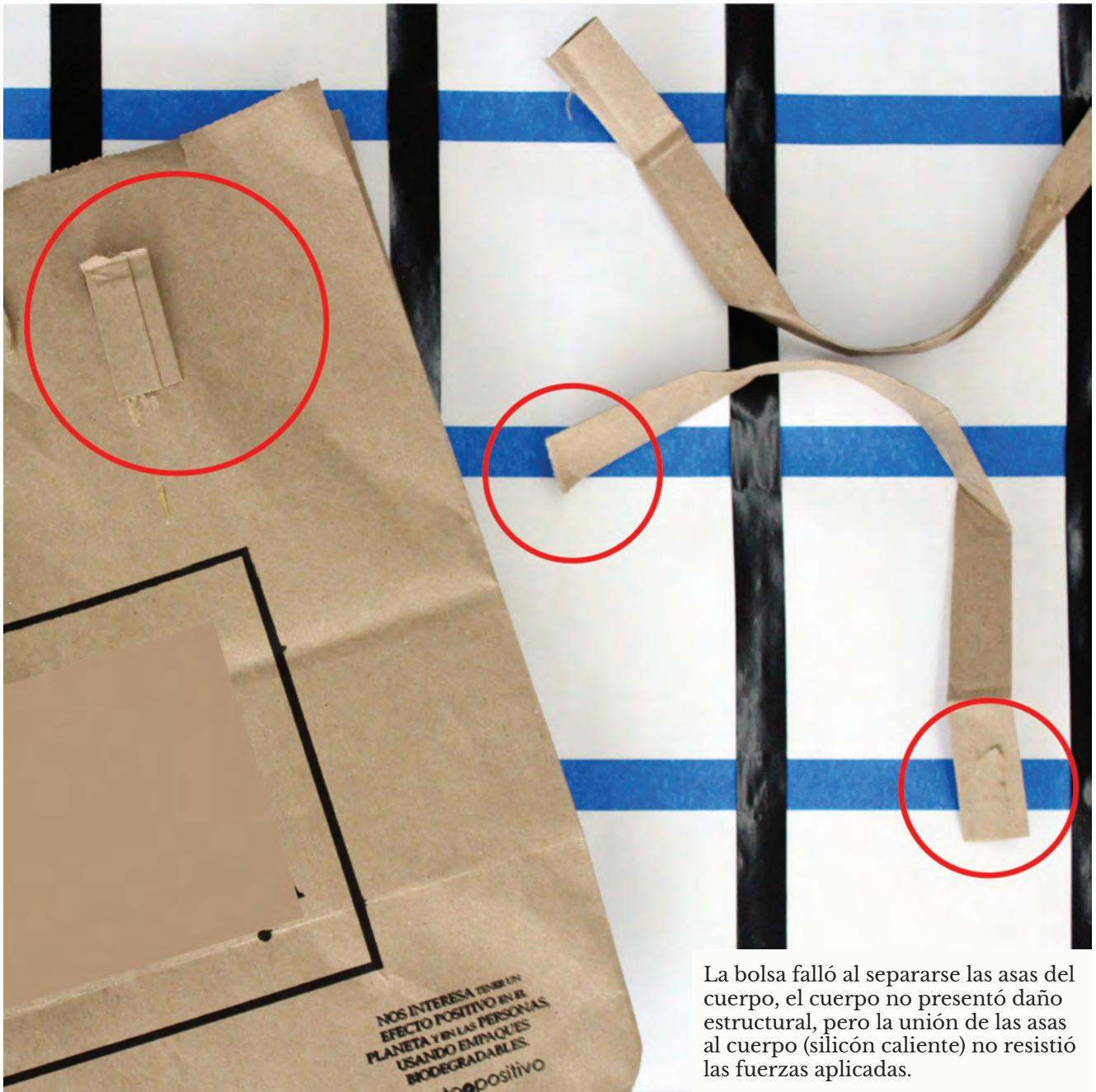
La bolsa falló al separarse las asas del cuerpo, el cuerpo no presentó daño estructural, pero la unión de las asas al cuerpo (silicón caliente) no resistió las fuerzas aplicadas.
