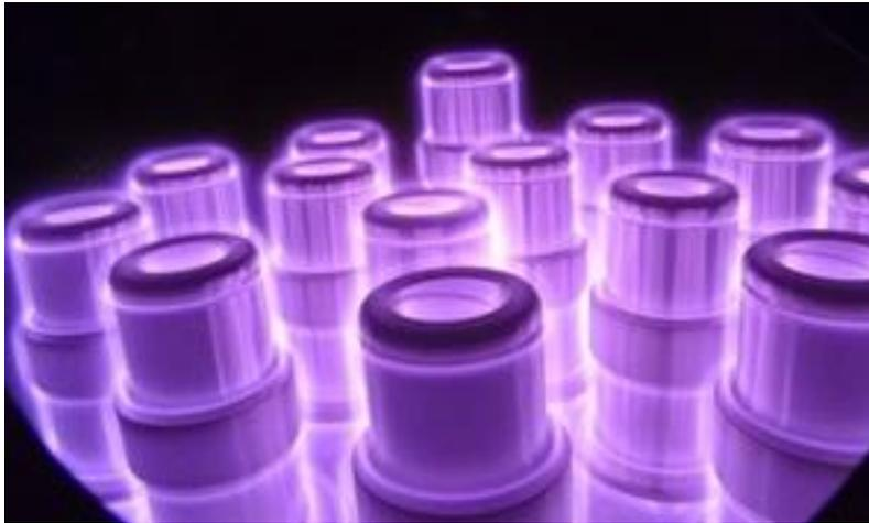
**Figura 4.6.** Ejemplo de nitruración por plasma. [15]
