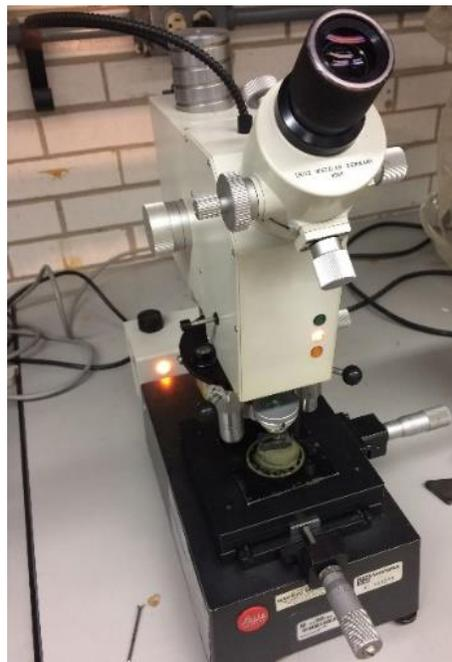
**Figura 4.11.** Microdurómetro «*LEITZ WETZLAR*».
