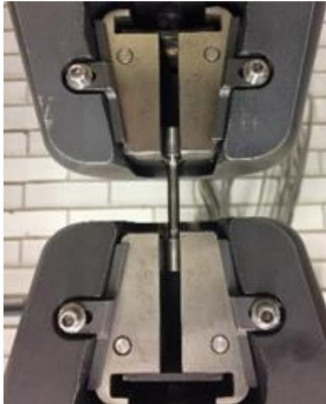
**Figura 4.7.** Prueba de tracción en acero SAE 1018.
