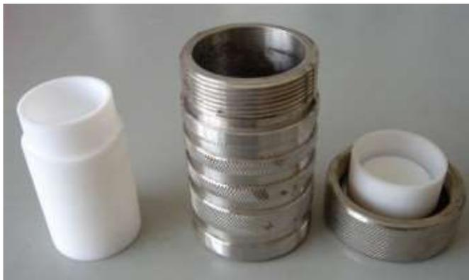
Figura 1.2 Autoclave de acero inoxidable revestido de teflón [8]
