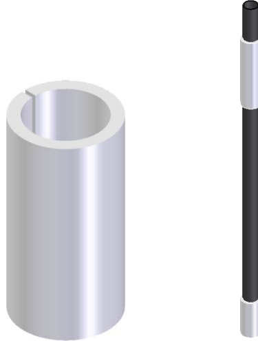
Figura 4.15: Mango de espuma de polietileno y distribución de empuñaduras en tubo ABS de 40 (mm).
