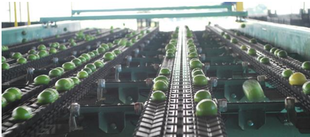
Figura 1.18: La clasificación por tamaño es automatizada en algunos casos (fotografía). Recuperado de www.limonesamatlan.com
