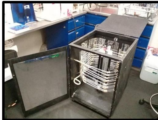
Figura 2.2. Sistema de foto-reactor en continuo, armado y colocado en el laboratorio
