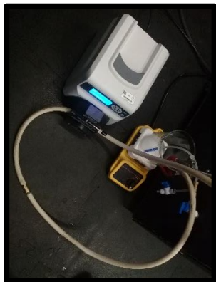
Figura 2.2. Sistema de foto-reactor en continuo, armado y colocado en el laboratorio
