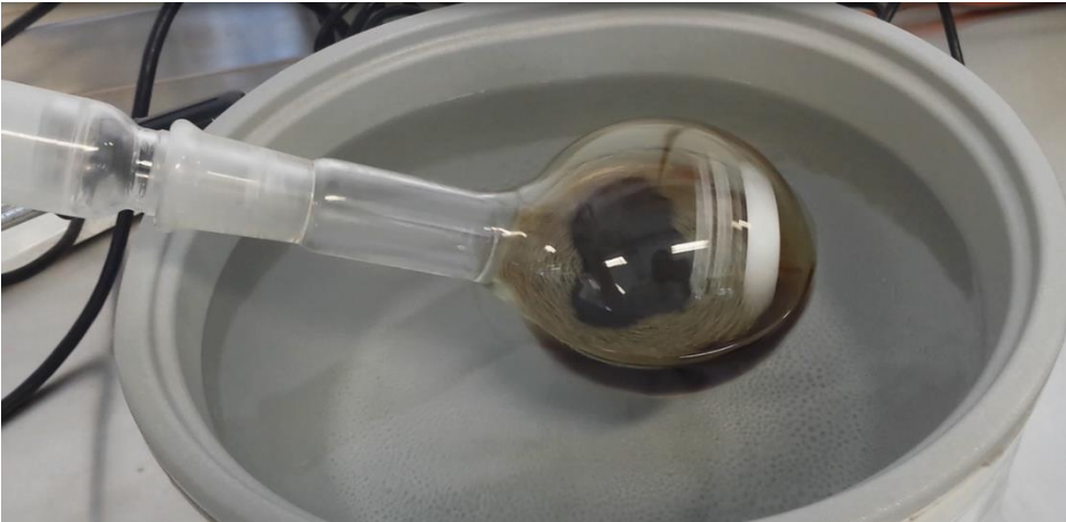
Figura 4 Proceso de evaporación utilizando un rotavapor Buchi® para la concentración de los extractos acuosos.
