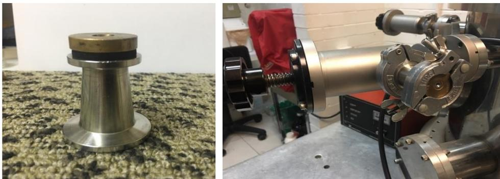
*Figura 3.4 Arreglo Experimental, para conectar los tres agujeros a la cámara de vacío.*
