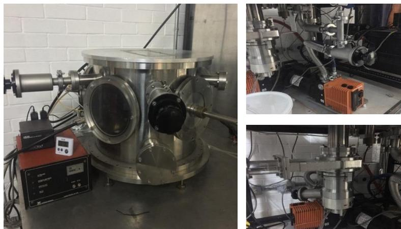
**Figura 3.2 Sistema de Vacío De 60 litros con Bomba mecánica y turbo molecular**
