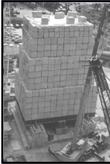
Figura 23.- Sistema de reacción con peso muerto (Handley & Bullivant, 2006; M.J. Tomlinson, 1994)
