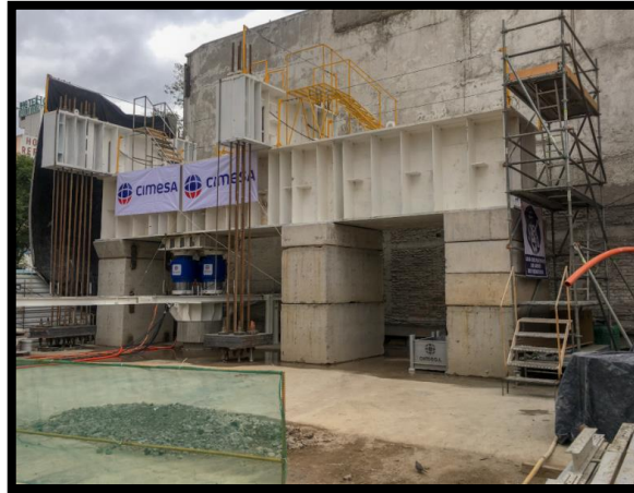
Figura 57.-Sistema de reacción y Marco de referencia e instrumentación
