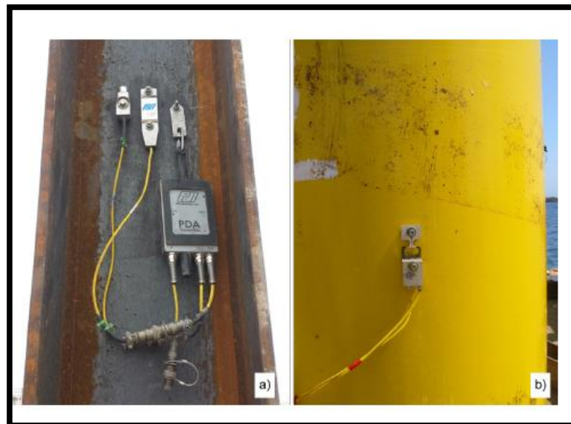
Figura 15.-a) Acelerómetro, medidor de deformación y transmisor Wifi, b) medidor de deformación combinada y acelerómetro (Hannigan et al., 2016)
