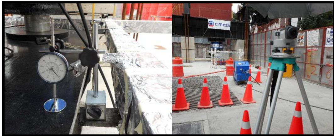
Figura 92.- (a) Transductores de desplazamiento (b) Topografía convencional (CIMESA).
