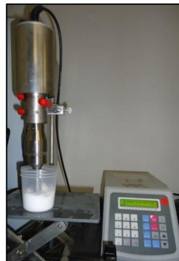
*Fotografía 6.- Aplicación de Ultrasonidos de Alta Frecuencia al Sistema.*
