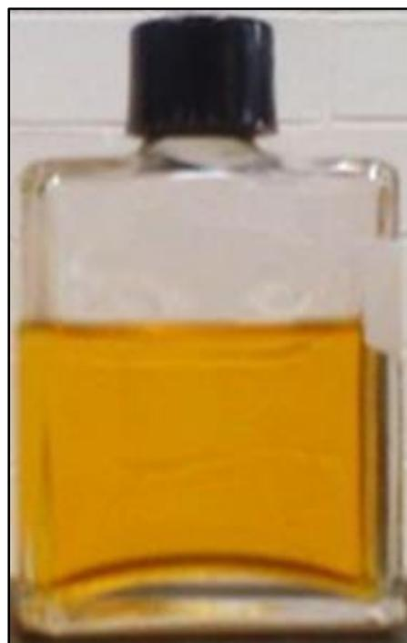
*Fotografía 11.- Sol del sistema mixto de  $\text{SiO}_2\text{-TiO}_2$ .*
