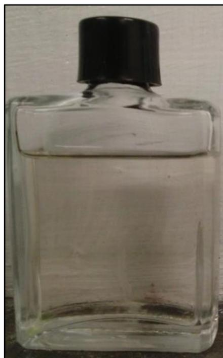
*Fotografía 12.- Sol del sistema mixto de  $\text{SiO}_2\text{-Al}_2\text{O}_3$ .*
