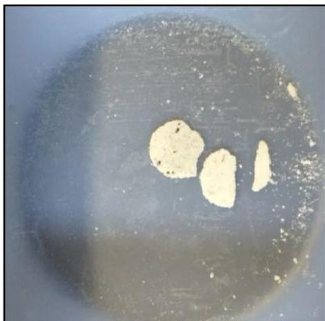
*Fotografía 28.- Pastillas de los Xerogeles de  $\text{SiO}_2\text{-Al}_2\text{O}_3$ .*
