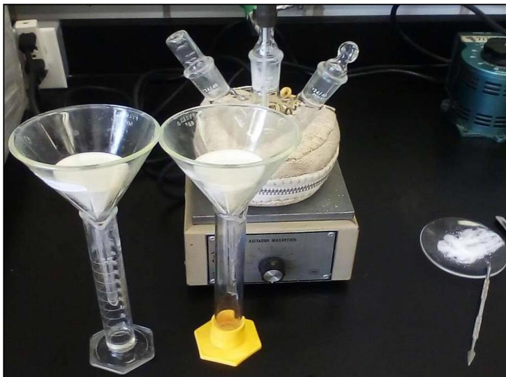
*Fotografía 3.- Filtrado de la Solución y Obtención de Sol A2.*
