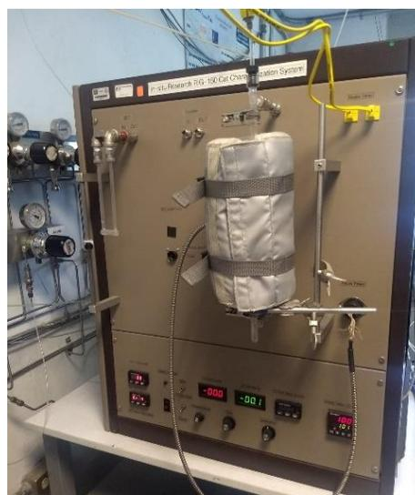
*Figura 6 Reactor tubular de cuarzo acoplado a sistema térmico.*
