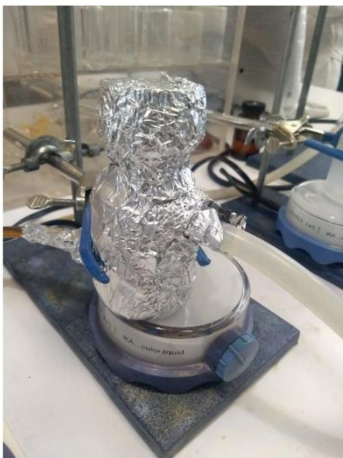
*Figura 5 Reactor batch aislado de la luz.*
