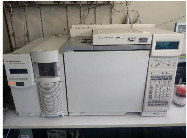
Figura 7 Cromatógrafo Agilent Technologies 6890N.
