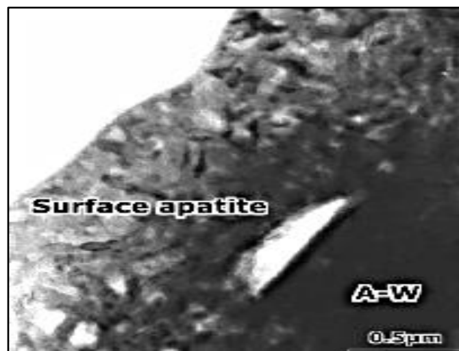
Imagen 7. Microscopia Electrónica de Transmisión de la sección transversal de una capa de apatita formada en una vitro cerámica A-W en SBF.
