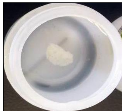
Fotografía 21.- Inmersión de las Pastillas en S.B.F.
