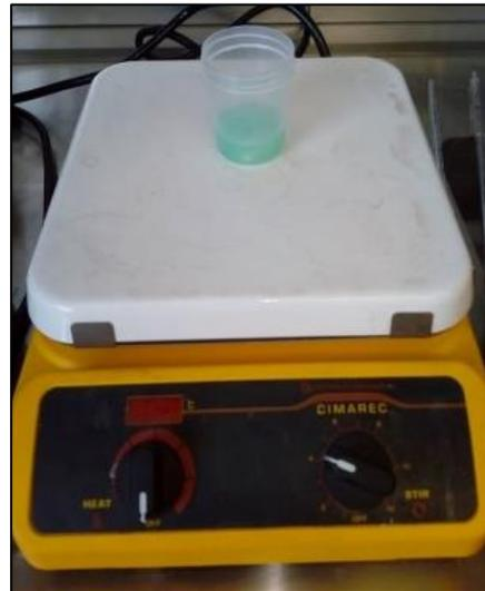
*Figura 16.- Sistema de Reacción de Síntesis para el Componente Inorgánico.*
