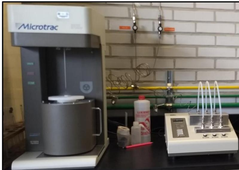
*Figura 29.- Equipo de Propiedades Texturales, de la Marca Bell Japan y desgasificador utilizando Helio molecular y Nitrógeno como adsorbato.*
