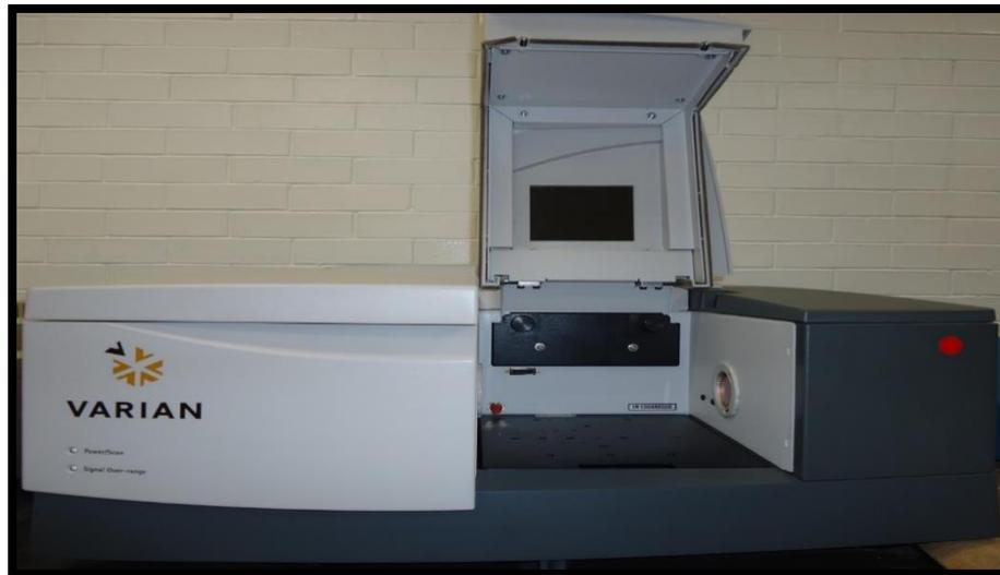
*Figura 26.- Equipo de FT-IR, de la Marca Varian Modelo 640.*
