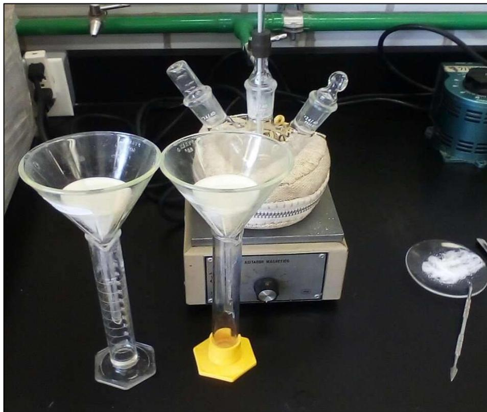
*Figura 14.- Filtrado de la Solución y Obtención de Sol A2.*
