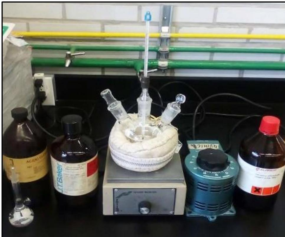
*Figura 13.- Sistema de Reacción para la Síntesis del Sol A2.*
