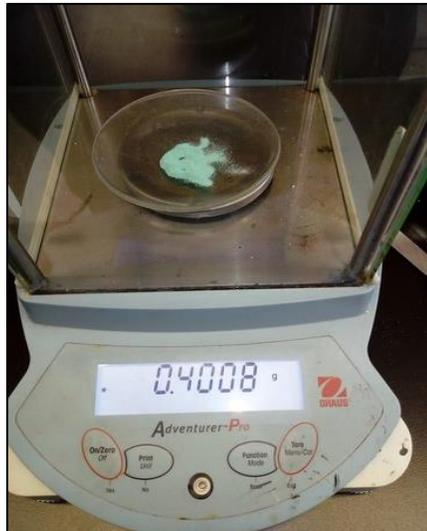
*Figura 15.- Pesado del precursor de Níquel en la Balanza Analítica.*
