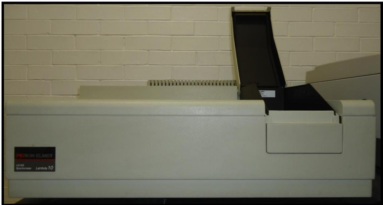
*Figura. 25.- Equipo de Ultravioleta Visible (UV-Vis), de la Marca Perkin Elmer, Modelo Lambda 10.*
