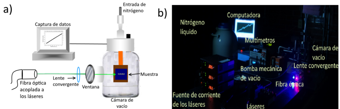
Figura 2.10: a) Esquema del sistema de medición eléctrica. b) Cuarto oscuro para mediciones ópticas y eléctricas. En ambos se presentan los medios utilizados para llevar a cabo las mediciones.
