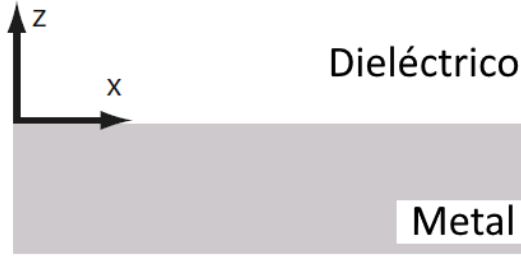
Figura 1.3: Representación de una interfaz dieléctrico - metal, ambos sobre el eje Z . Adaptado de [1] .
