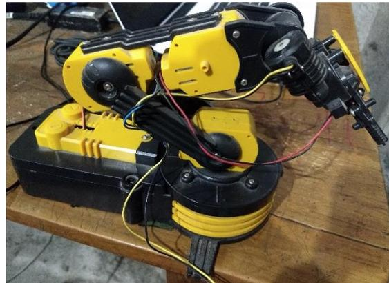
Figura 27: Brazo K-680 utilizado en el proyecto. Elaboración propia.
