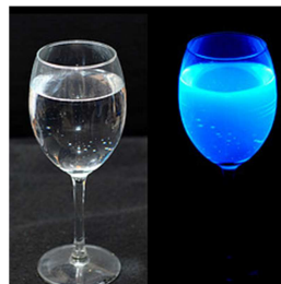
Figura 29. Fluorescencia de quinina. Se puede apreciar un brillo intenso en la superficie y la amortiguación de la fluorescencia en el centro de la solución.
