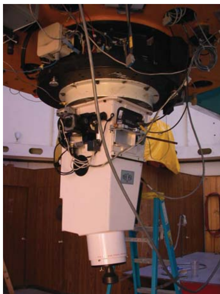
Figura 3.15: Espectrógrafo Echelle-REOSC instalado en el telescopio de 2.12m en el OAN-SPM.
