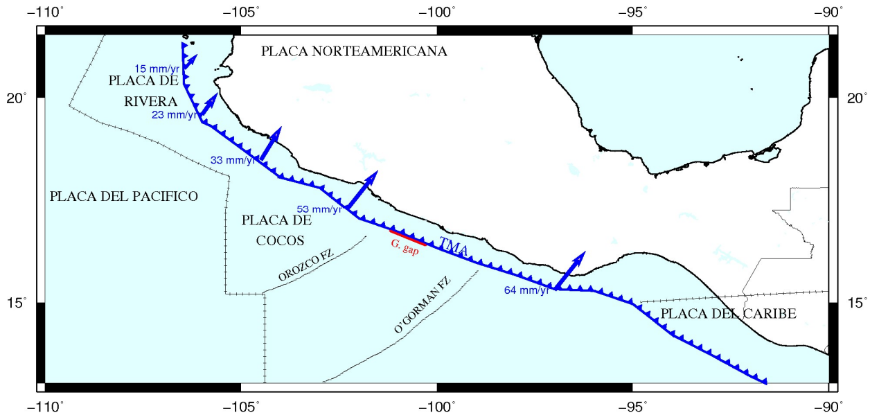
Figura 1.1 Mapa del territorio mexicano mostrando las placas tectónicas que lo conforman y la velocidad aproximada de subducción a lo largo de la trinchera Mesoamericana (TMA).
