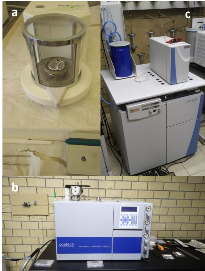
Figura 15. a) Balanza analítica Mettler Toledo XPR2U, b) Analizador elemental Costech 4010, c) Espectrómetro de masas con relación de isótopos Finnigan Delta V Plus.
