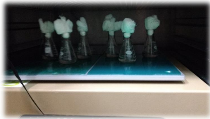
Figura 10. Cultivo en agitación constante. Fotografía que ilustra el cultivo de PVs en suspensión, en matraces Erlenmeyer de 25mL de capacidad.
