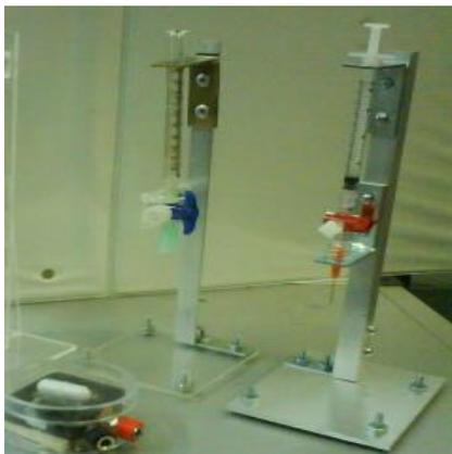
**Fig. 2.4.** Dispositivo para microtitulación ácido–base
