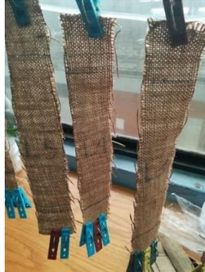
Figura 51. Probetas de yute recubiertas con BP1
