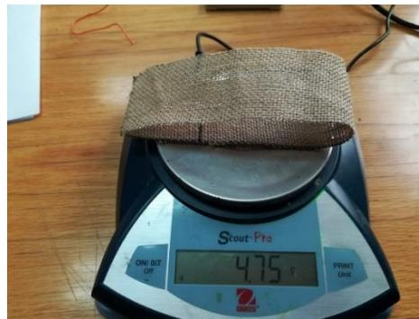
*Figura 41. Báscula Ohaus para obtener el peso de las probetas textiles tipo "C"*
