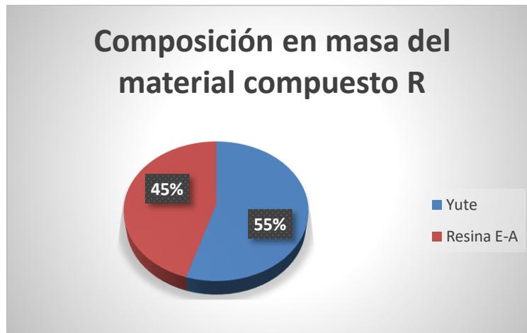
Figura 55. Gráfico de composición másica del material compuesto R
