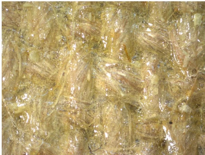
*A 40. Imagen estereoscópica del material compuesto A-N-R*
