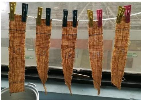
*Figura 43. Probetas recubiertas por bioplástico BP3*
