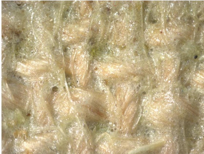
*A 39. Imagen estereoscópica del material compuesto N-R*
