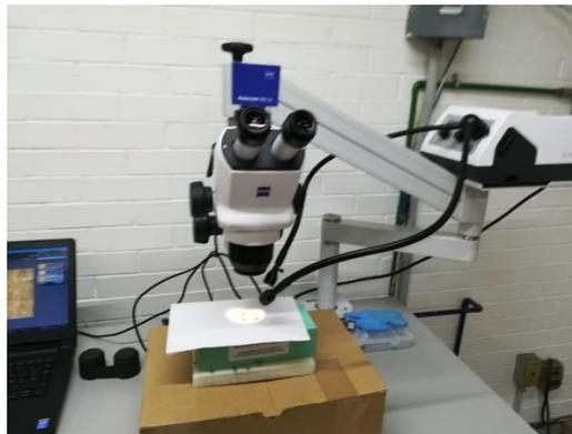
Figura 32. Estereoscopio Zeiss con cámara AxiocamERc 5s
