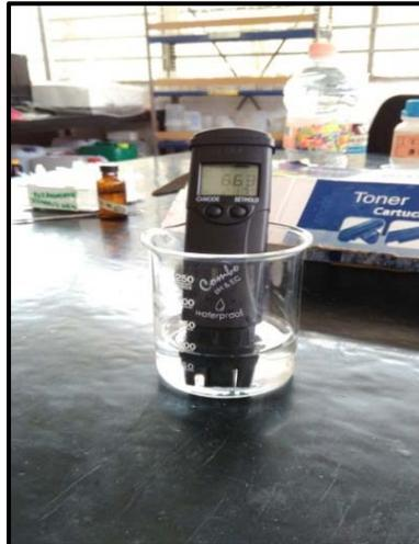
Figura 14. Potenciómetro digital Woonsoket.
