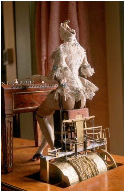
Imagen 57 Interprete de tímpano 1772, detalle de las levas.
