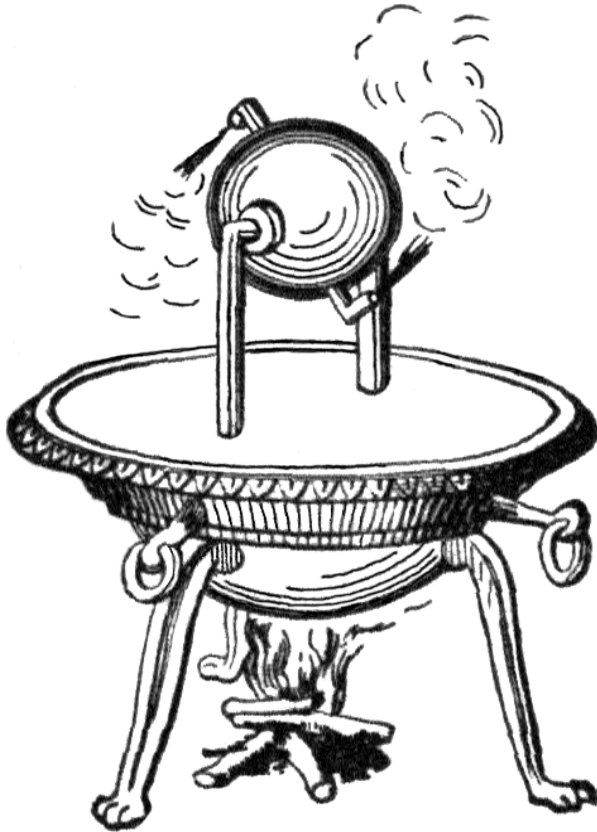
Imagen 45. Aeolipile, o maquina de vapor de Hero de Alejandría.
