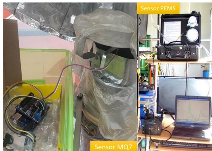
Figura 5.1: Calibración estándar de sensor MQ7: El sensor se colocó a la salida del ducto de emisiones de la estufa en prueba.
