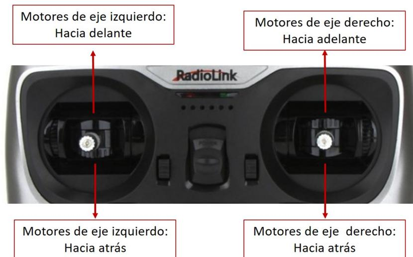
Figura 3.3: Distribución de controles de la emisora. Stick derecho encargado del control de los motores DC del eje derecho y stick izquierdo encargado del control motores DC del eje izquierdo del vehículo.
