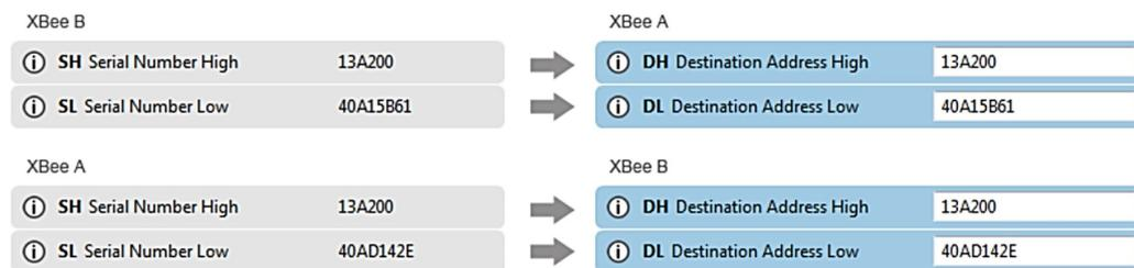
Figura 4.8: Configuración modo AT: Para que los módulos A y B se comuniquen, se debe configurar la dirección de destino (DH + DL) de XBee A como la dirección MAC (SH + SL) de XBee B, y viceversa.
