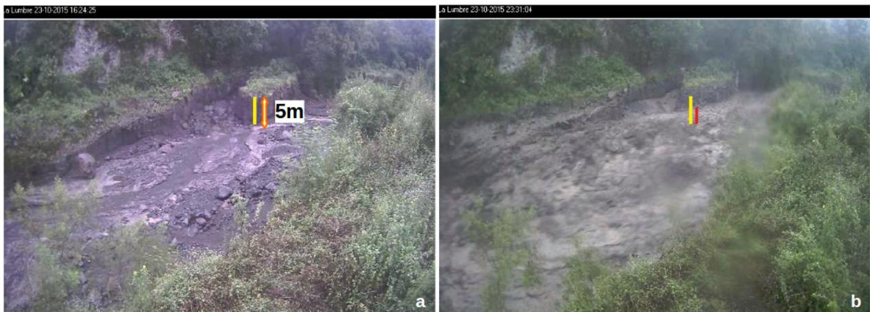
Figura 17. Ejemplo de medición de la altura del flujo: a) Referencia de campo, la línea amarilla que mide 5m b) Ejemplo de medición de la altura a las 23:30 GMT (línea roja). Dado que la línea de referencia está fija, también se puede observar el carácter erosivo del flujo con relación a la incorporación de parte de la terraza donde se encuentra la referencia.
