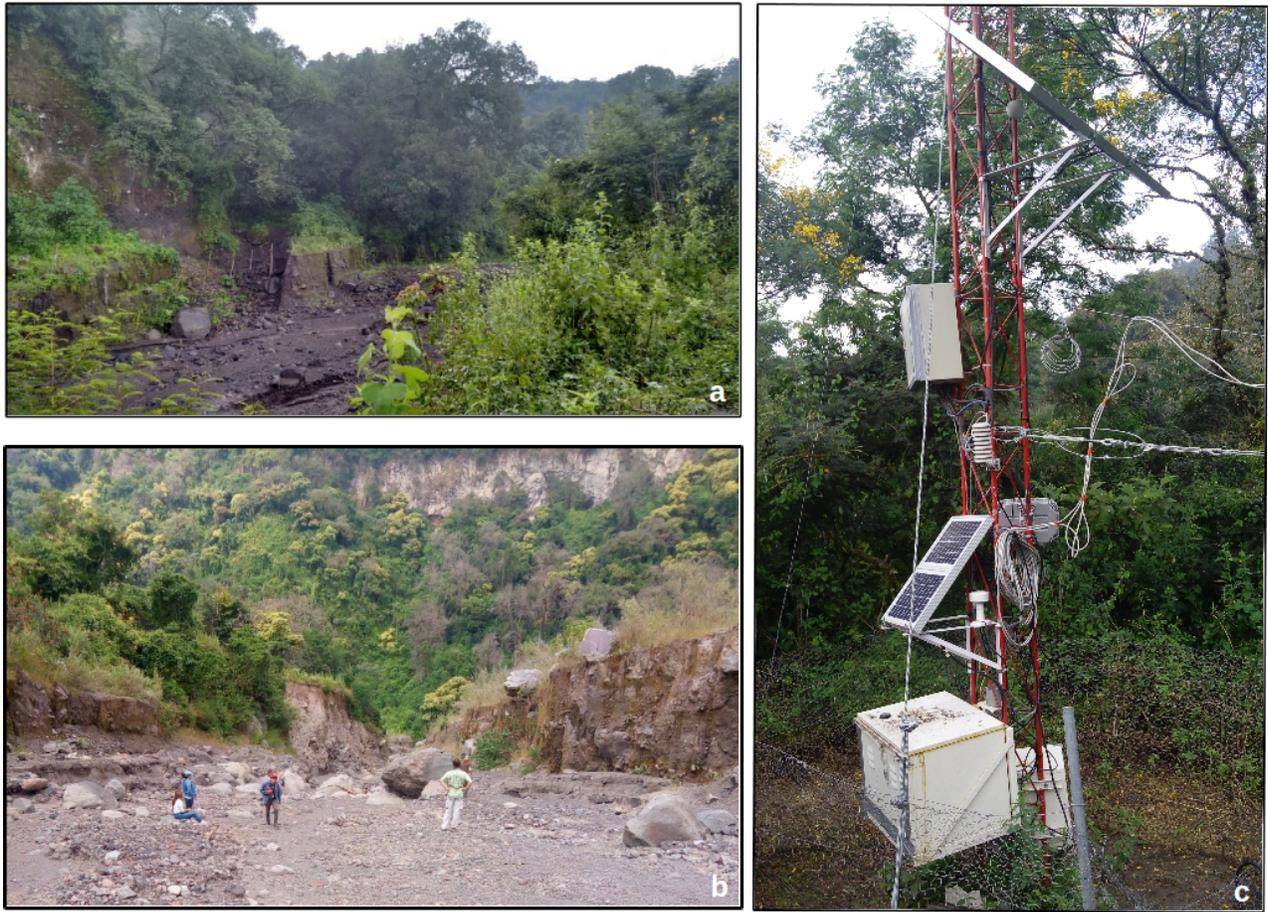
Figura 4. Estación de monitoreo en la barranca La Lumbre: a) Vista de la videocámara, b) Vista canal abajo y c) Torre de la estación.
