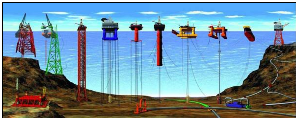
Figura 3 Estructuras para plataformas marinas. (National Oceanic and Atmospheric Administration, 2010).
