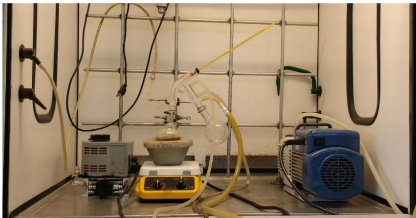
Figura 5.1. Sistema empleado para purificación del VP. Se aprecia los matraz bola, mantilla de calentamiento, refrigerante y bomba de vacío.
