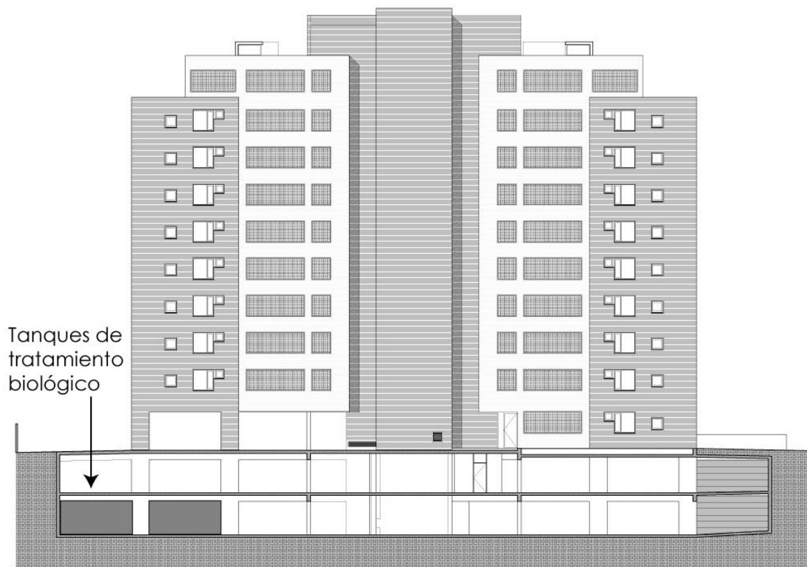
Figura 6.7b. sistemas de tratamiento biológicos en edificios Modificado a partir de González (2013)
