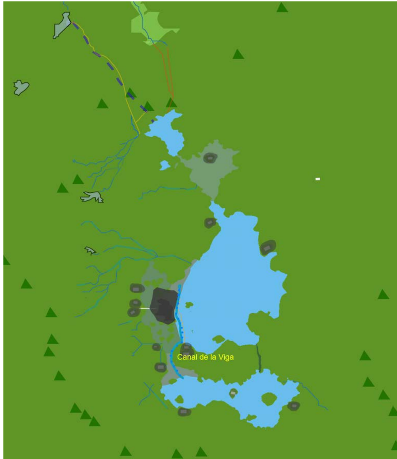
Esquema 10. Canal de la Viga. Además del Canal de la Viga representado por la línea azul que comunicaba el Lago de Texcoco con el Lago de Xochimilco; también se observa una línea oscura que conecta el lago de Texcoco con el de Chalco y se puede apreciar la etapa uno del Túnel de Tequisquiác, al norte de los lagos en color rojo.
