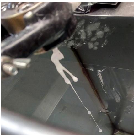
Figura 42: Tapón de polímero ocasionado por la falta de empuje del agua
