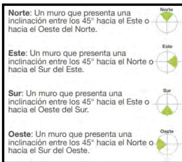
Figura 0.00 Orientación de muros según la NOM-008-ENER
