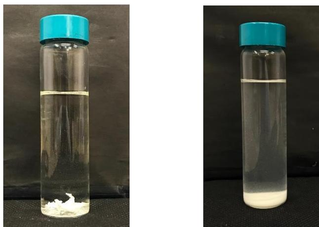
**Figura B\_IV\_4.** Conversión obtenida al finalizar la polimerización. Látex estable al final de la síntesis (izq.), Látex con separación de fases al finalizar la síntesis (der.)
