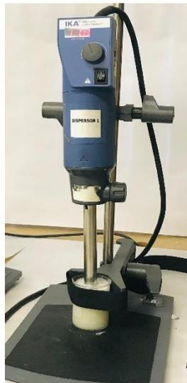
**Figura 30.** *Dispersor IKA, utilizado para las pruebas de estabilidad de látex.*
