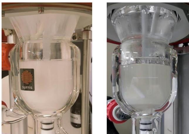
**Figura 42.** Cambio de coloración de la emulsión. Al inicio (izq.) y al final (der.) de la reacción
