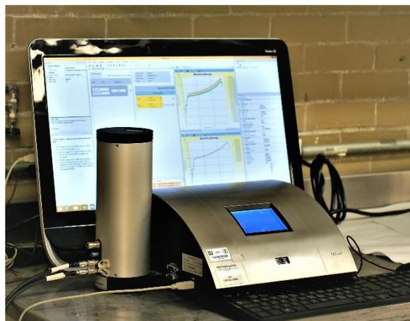
**Figura 27.** *Equipo MultiScan MS20, utilizado para las pruebas de estabilidad de fases.*
