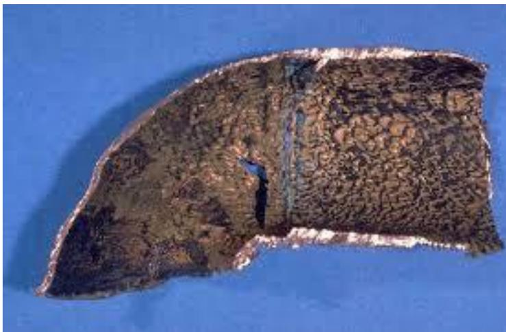
**Figura 3.** Codo de acero inoxidable afectado por el fenómeno de erosión. (López Ochoa, 2014)
