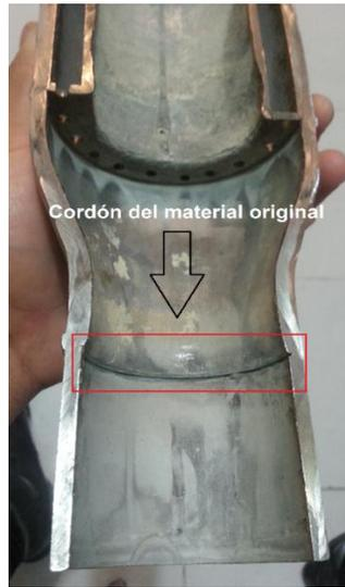
**Figura 67.** Cordón de soldadura observado mediante microscopia de barrido y estereoscópico.
