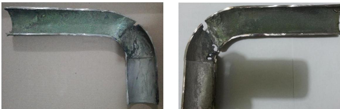
**Figura 22.** Corte longitudinal del “Codo”
