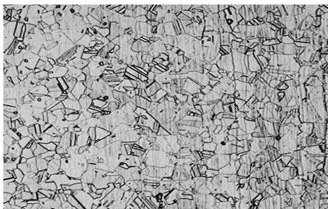
**Figura 14.** Microestructura típica 304 formada por grandes granos austeníticos vista a 500x con ataque de ácido oxálico al 10%. (Acero Inoxidable 304, 2009)
