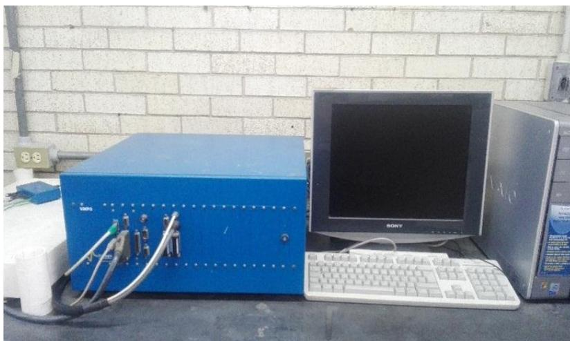
**Figura 30.** Potenciostato utilizado en las técnicas electroquímicas
