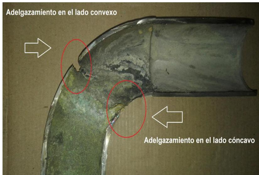
**Figura 68.** Adelgazamientos presentados en la pared del codo.
