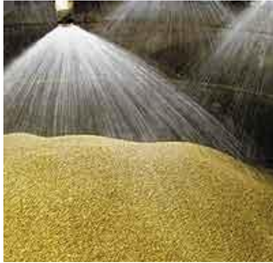
Figura 24. Como se hidrata la cebada con aspersores
