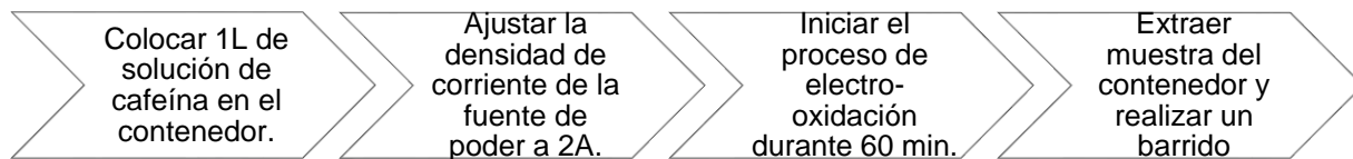
Figura 20 Diagrama de flujo para la degradación de cafeína en la celda electroquímica
