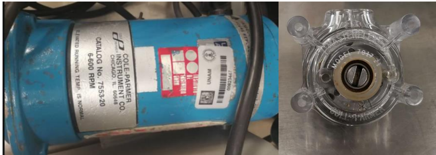
Figura 15 Bomba Cole-Parmer 7553-20, 6-600 RPM con dos rotores Cole-Parmer modelo 7017-21
