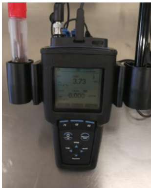
Figura 17 Equipo multiparámetros Orion Star A329, marca Thermo Scientific
