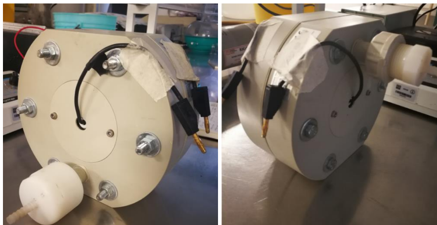
Figura 9 Celda electroquímica DiaCell® 106
