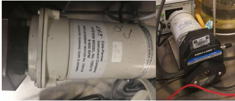
Figura 14 Bomba peristáltica Cole-Parmer, 7553-70, 6-600 RPM, cabezal 77200-60.
