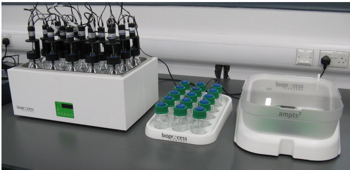
Figura 4.5.1 Sistema automático de pruebas de potencial bioquímico de metano (AMPTS II) Bioprocess Control.
