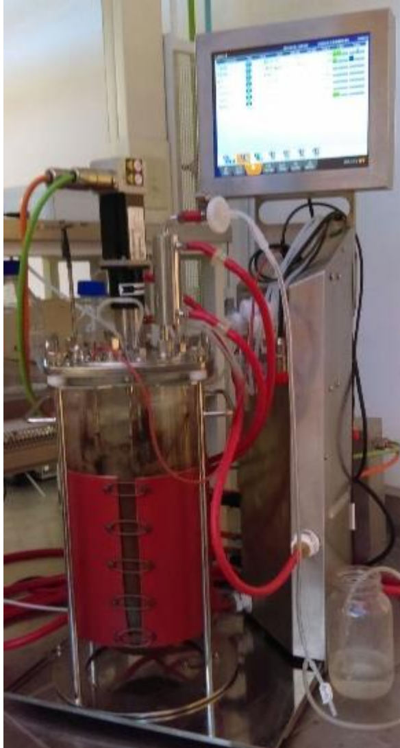
Figura 4.3.1 Reactor CSTR InforsHT 13L utilizado para la aclimatación de microorganismos nativos del efluente vitivinícola blanco a condiciones hipertermófilas (70°C)
