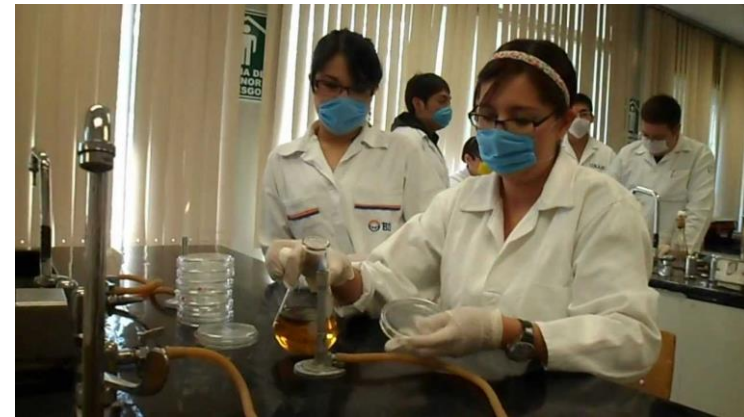
Imagen 52.- Llenado de cajas Petri con medio de cultivo. Tomado de goo.gl/ENNYhp .
