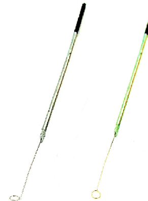
Imagen 47.- Asa bacteriológica modificada a la izquierda y asa bacteriológica normal a la derecha.
