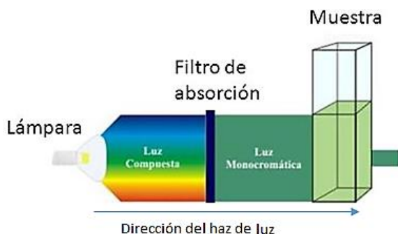
Imagen 6.- Dirección del haz de luz de Fotocolorímetro / Espectrofotómetro. Tomado de goo.gl/7QjGvn.
