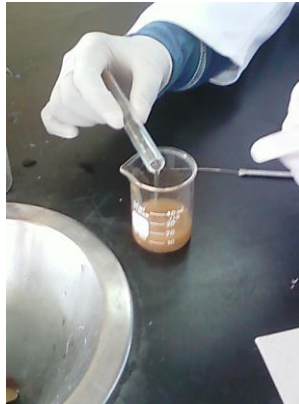
45.- Forma de decantar la muestra centrifugada. Tomado de goo.gl/xxJtV9
