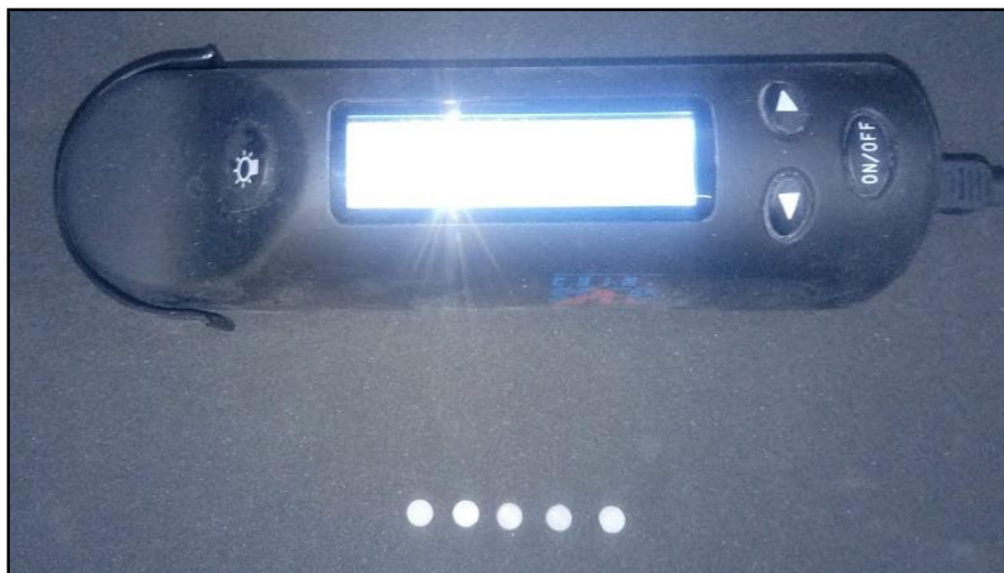
Figura 25.- Colorímetro digital y pastillas de sellador experimental. Fuente: directa.
