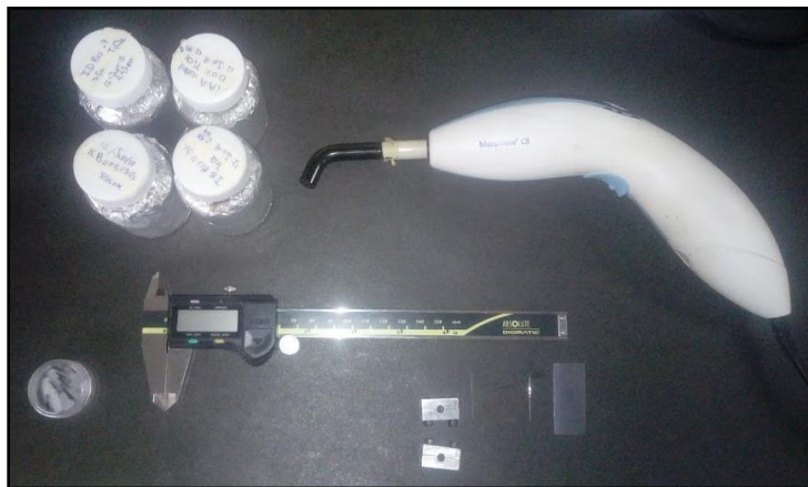
Figura 21.- Equipo, instrumental y material para pruebas de profundidad de curado. Fuente: directa.
