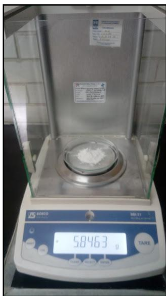
Figura 19.-Pesado de reactivos en balanza analítica. Fuente: directa.
