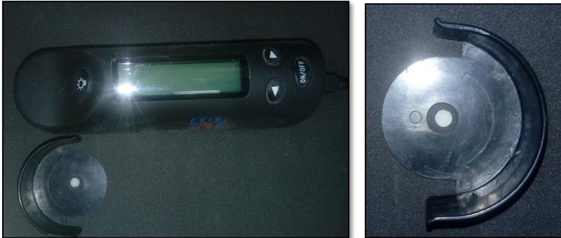
Figura 26.- Colocación de la pastilla en el colorímetro para su lectura.
