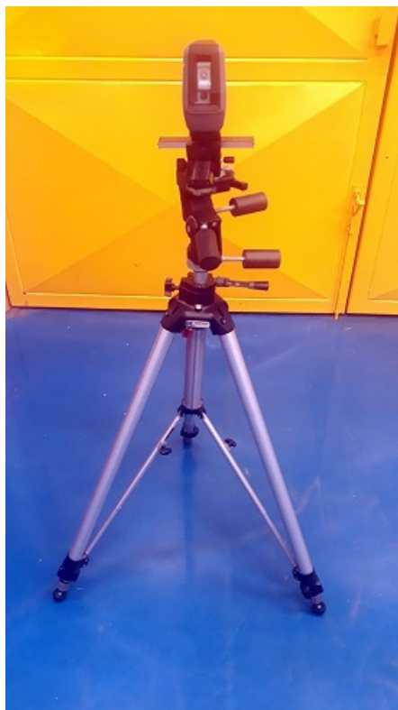
Figura 2.11: Sistema SKIL utilizado para la alineación del haz de partículas que se obtiene del LEMA, el blanco y los sistemas telescópico.
