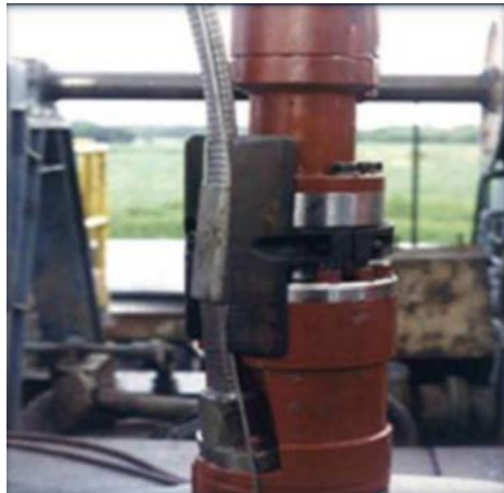
Figura 18. Conexión del motor (UNAM, 2013)
