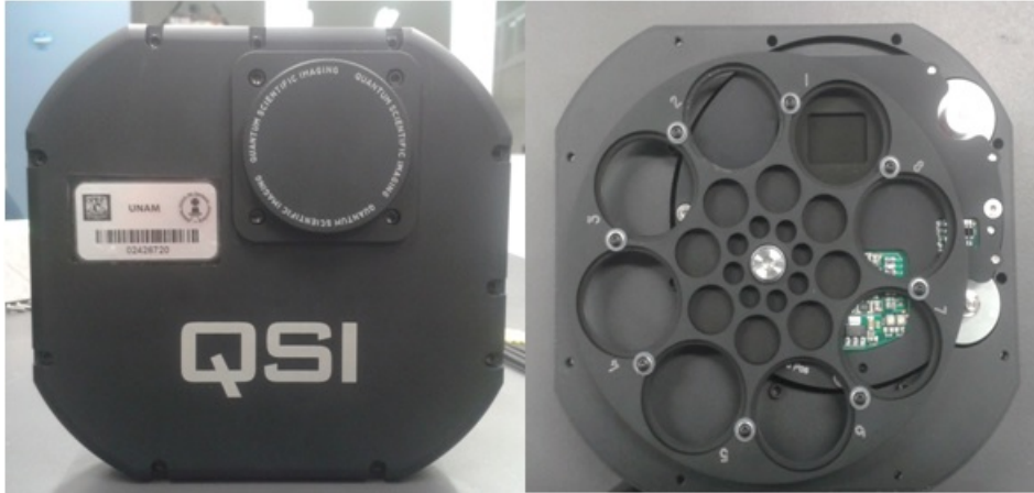
Figura 3.5: Cámara QSI (izquierda). Rueda con 8 posiciones para los filtros (derecha).
