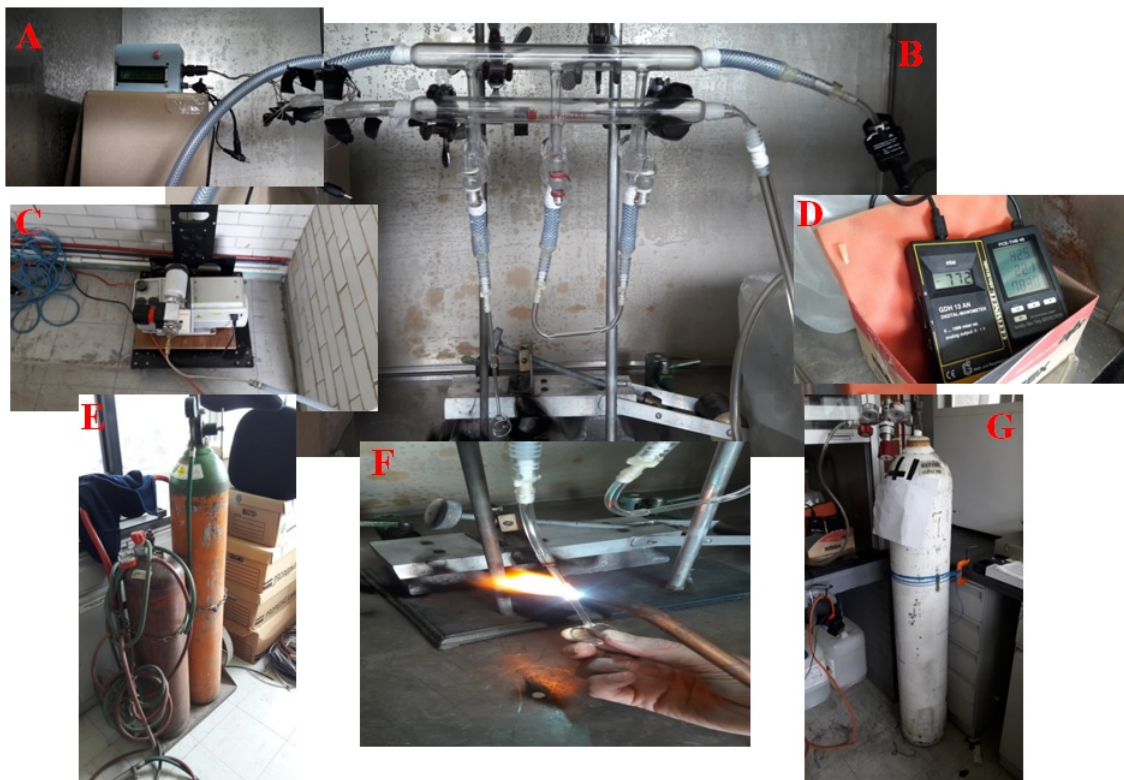
Figura 7.4: A) Medidor de presión absoluta. B) Cámara de mezcla. C) Bomba de vacío. D) Medidor de presión relativa. E) Tanques de acetileno y oxígeno. F) Celda de cuarzo y su cierre. G) Tanque de bióxido de azufre.
