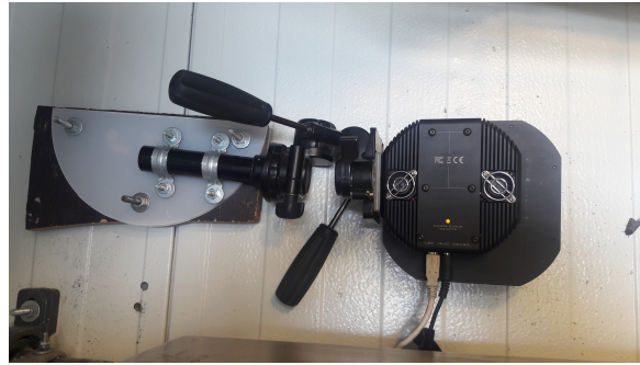
Figura 3.8: Cámara UV instalada de forma permanentemente en la estación de Altzomoni.
