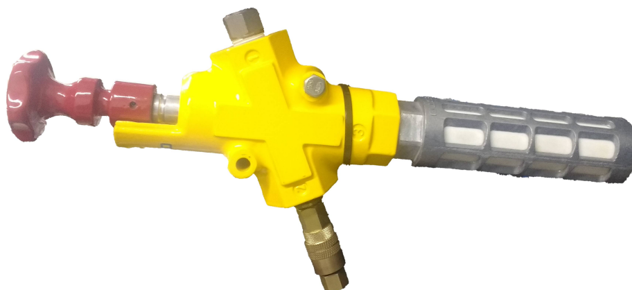
Figura 3.4. Parada de emergencia
