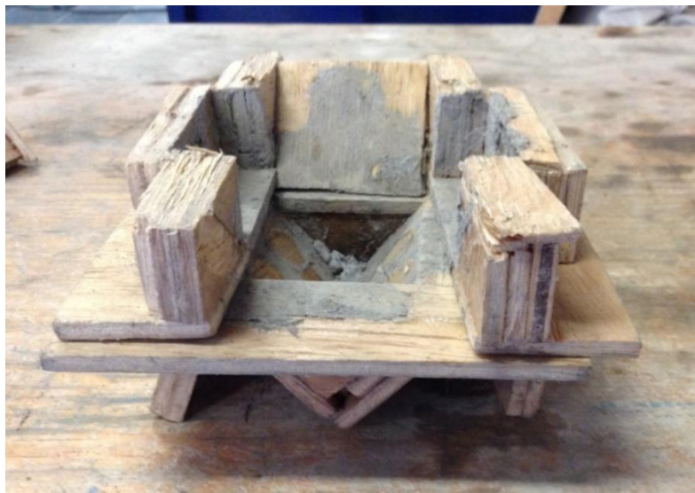
Figura 26 – Segundo prototipo de cimbra
