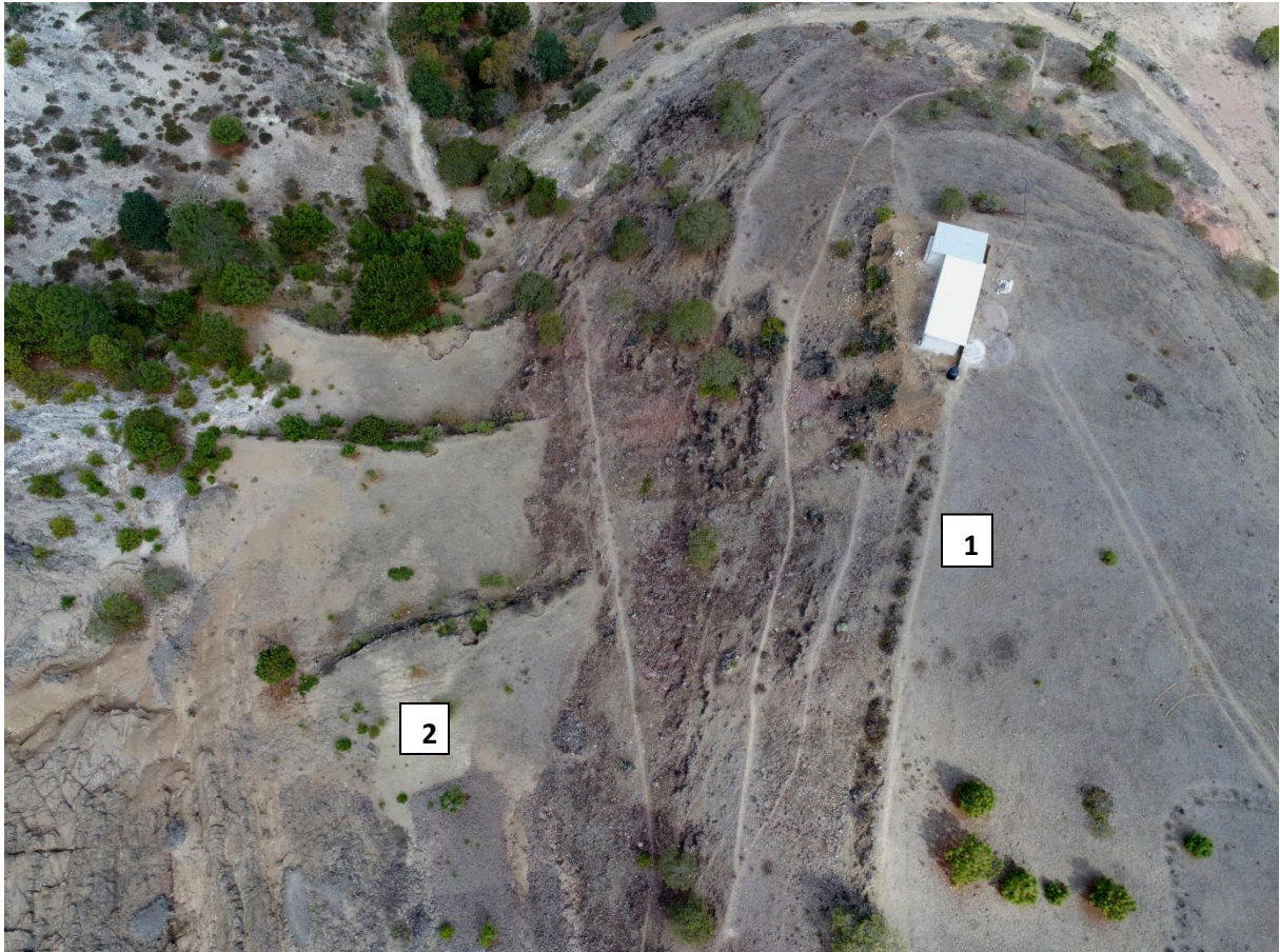
Figura 3.10 Vista en planta de terrazas de contorno (1) y de tipo lamabordo (2), Sistema Panteón, Santo Domingo Tonaltepec. Foto: Ricardo Garnica Peña, altura promedio del vuelo de dron: 80 m, Marzo de 2018.
