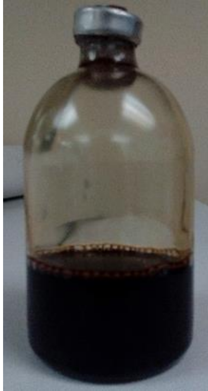
Figura 3. 3. Hidrocarburos condensados estabilizados que se generan en las fraccionadoras 1,3 y 4 del CPG Burgos
