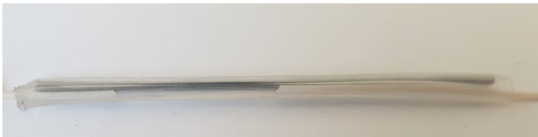
Figura 2.15 Empalme con manga de empalme
