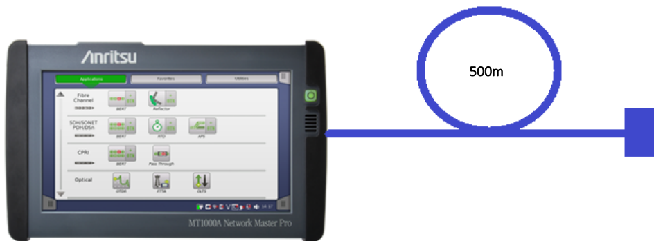
Figura 3.7 Medición del primer tramo del enlace
