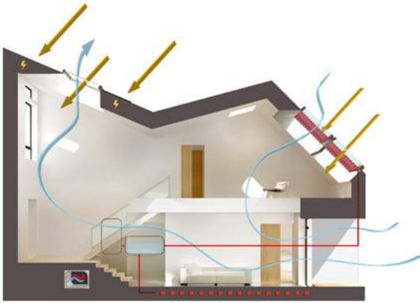
5.1 Ventilación cruzada en edificios. (Imagen) Año 2010. Fuente: www.construmatica.com
